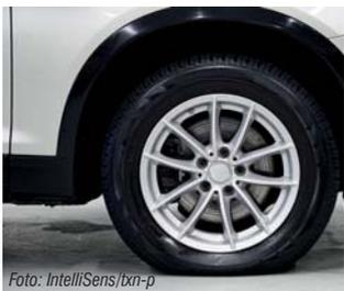
Mit bloßem Auge kaum zu erkennen: Dieser Reifen hat einen Minderdruck von 60 Prozent. Kein Wunder also, dass Reifendruckkontrollsysteme mittlerweile für Neuwagen vorgeschrieben sind.
