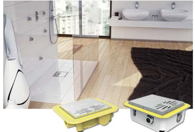
Im Altbau ist das Duschabwasser mit bodengleichen Duschen nicht wegzukriegen. Es fehlen oft nur wenige Zentimeter, die das vorhandene Abwasserrohr zu hoch im Estrich liegt. Abhilfe schafft ein neues Produkt. Mit einer kleinen leistungsstarken Pumpe im neuen Bodenablauf wird das Abwasser in die alte Leitung gefördert. Foto: Pentair Jung Pumpen/trd/akz-o
