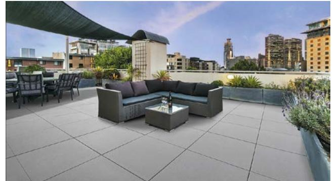
Die XXL-Außenplatten Vios passen sehr gut zu einem eleganten und urbanen Architekturstil. Die Elemente aus robustem Betonstein sind pflegeleicht sowie frost- und tausalzbeständig. Sie sind im Format 80 x 80 Zentimeter und drei Farbtönen erhältlich. Foto: Kann/txn
